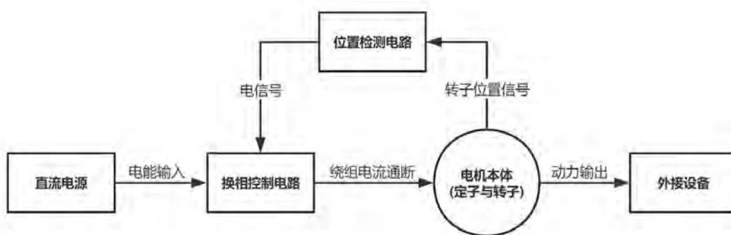
图 1 永磁无刷直流电机运行原理
